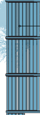
Brise-vue CHYPRE Brise-vue en pente réalisable (pente 10% maxi) Hauteur de brise-vue de 1,50 m à 2 m Entraxe poteaux maxi : 2 m (H ≤ 1,75 m) ou 1,60 m (H > 1,75 m)
