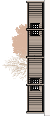
Clôture CONSTANCE Hauteur minimum 900 mm Hauteur de clôture jusqu'à 1,50 m Entraxe poteau maxi : 2,50 m Clôture en pente : réalisable (sur validation technique) Brise-vue : non disponible
