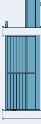
Coulissant autoportant Soubassement tôle obligatoire (sauf MAHÉ) Plusieurs modèles disponibles (voir pages modèles)
